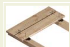
po následném přišroubování odstraníme vymezenovací tyčku (kolík) - hotovo!
