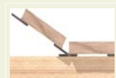
zasunout další terasové prkno a pevně přišroubovat na podložku Dielen-Fix - hotovo!
