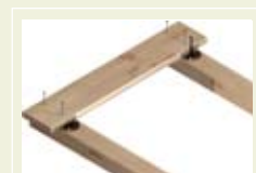
podložku TerrassenFix natočit na šířku mezery, zasunout vymezenovací podložku, terasové prkno přišroubovat
